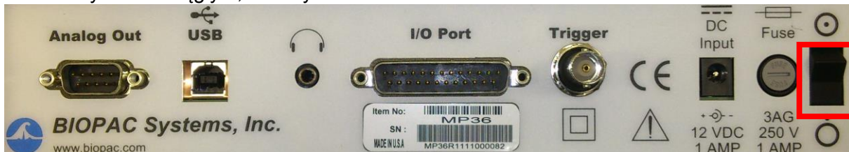
Rys. 4. Tylny panel MP36. Włącznik oznaczono czerwoną obwódką.
